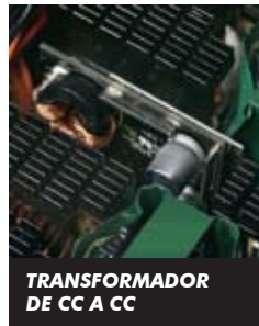
TRANSFORMADORES DOBLES COMPLETAMENTE INDEPENDIENTES
