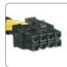
x 2 Compatible con EPS/ATX12V de 8 y 4 patillas
